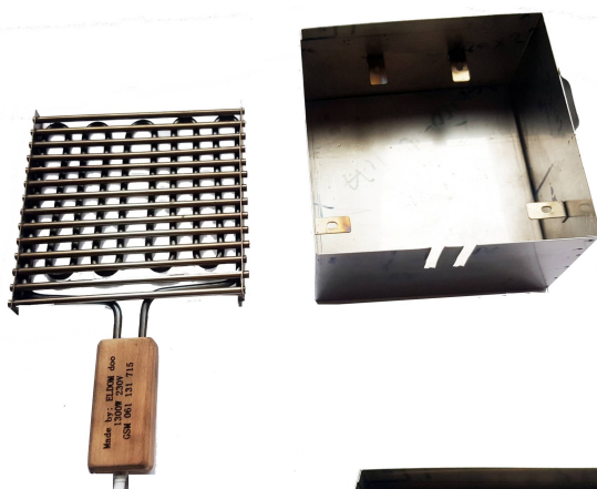
Kučište od inoxa dimenzija 200mm x 200mm x 100mm
